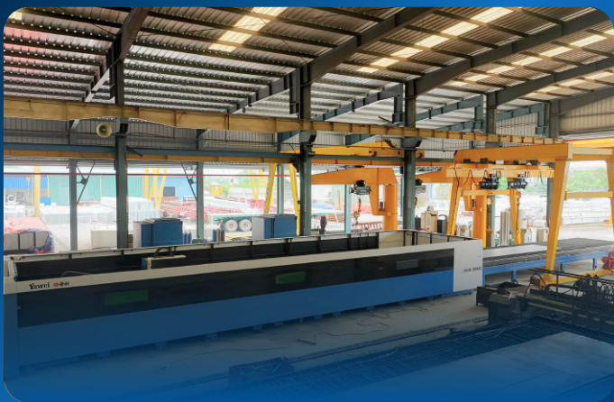
中厚板光纤激光切割机 (20kW、6kW、3kW)
