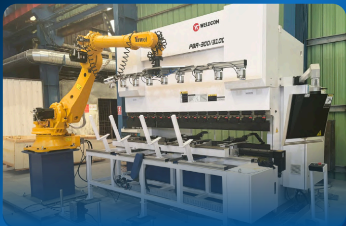
折弯机与折边机单元 (配置工业机器人)
